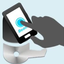
開啟 Vkey App 將接收到的金鑰儲存於 App 中，手機在 App 開啟狀態下，手機 NFC 位置靠近電子鎖線圈，此時螢幕會縮小，點選螢幕即將金鑰傳遞電子鎖，正確即可開門。
